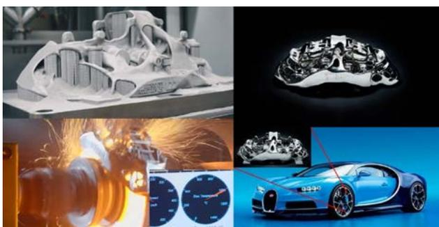
圖 5：法國知名車廠布加迪 (Bugatti) 以鈦合金金屬 3D 列印新型煞車卡鉗（圖片來源：法國布加迪 (Bugatti) 原廠）
