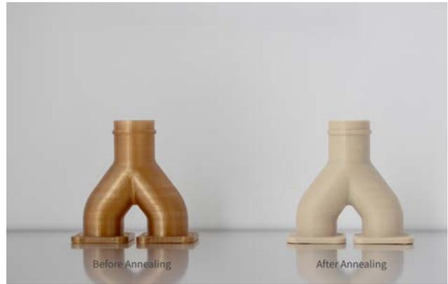
圖 2：由 VICTREX AM™ 200 絲材列印的歧管，左為退火前，右為退火後
