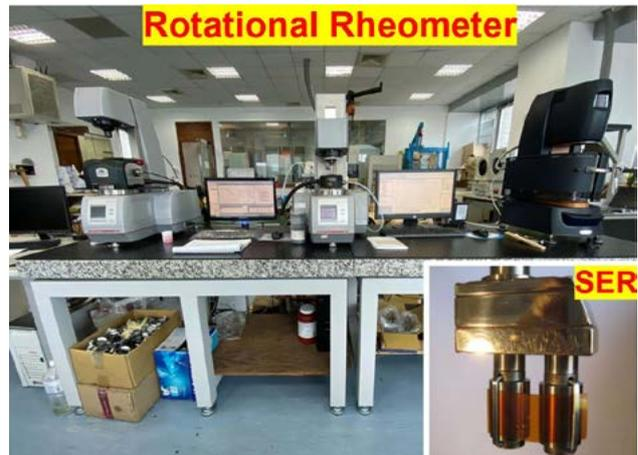
圖 4：塑料的黏彈性質量測設備：DMA（固態黏彈）、Rotational Rheometer（熔融態黏彈），及 SER（拉伸黏度夾具）
