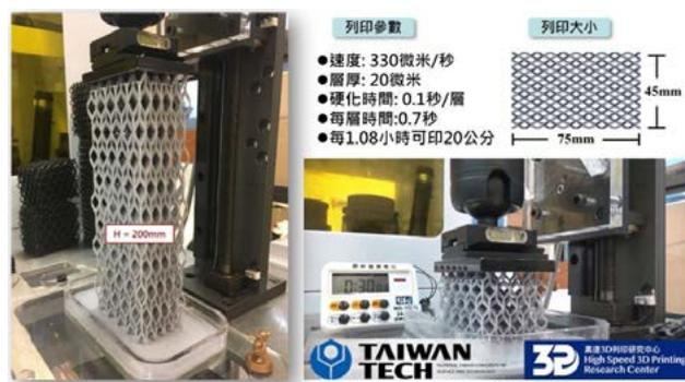
圖 4：高速光固化 3D 列印機臺（圖片來源：臺科大高速 3D 列印研究中心）
