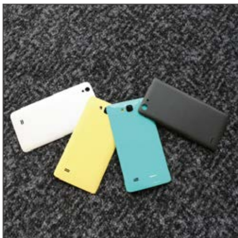
圖 4：增韌 PC 具高韌性、耐化學開裂，且易噴塗，常被應用於生產手機外殼，表格為 C200 性能典型值
