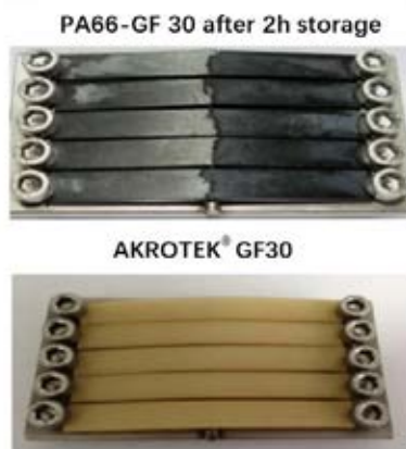
圖 2：在氯化鋅溶液中，PA66 僅浸泡 2 個小時就發生了開裂，而 AKROTEK ® 在 200 個小時後仍完好無損
