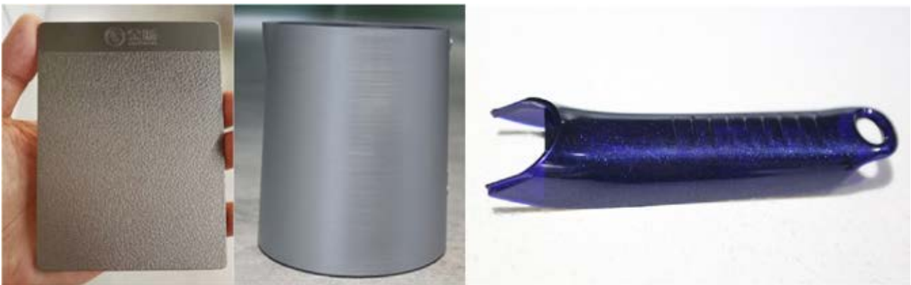
圖 8：免噴塗樣品圖例，由左至右分別為皮紋外觀、拉絲外觀，以及閃爍效果的免噴塗樣品
