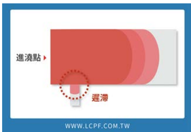
圖 1：肉厚差異所造成的流動遲滯現象
