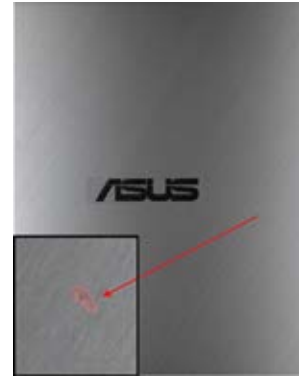
圖 2：AI 電腦視覺瑕疵檢測均勻表面花紋辨識
