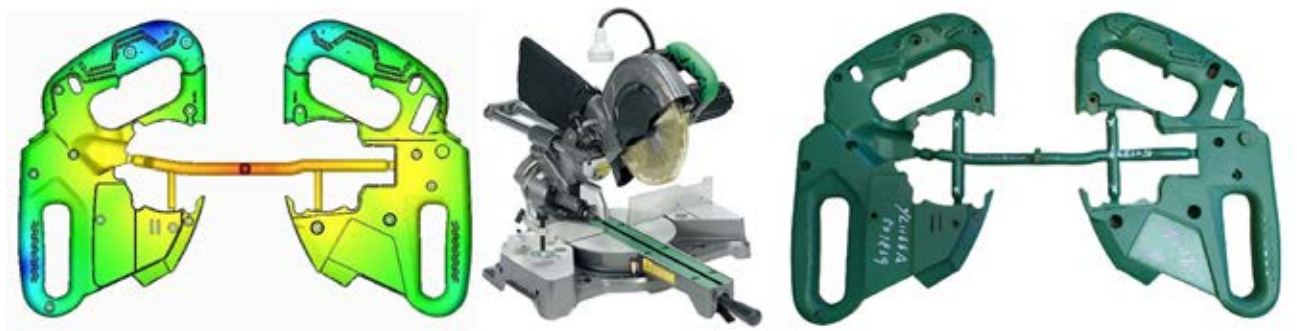
圖 7：企業組特別獎，好景塑膠「電動工具——複合式斜切機手柄的優化」。透過 Moldex3D，該產品成功減少 67% 的人工成本，並減少 33% 的原料成本
