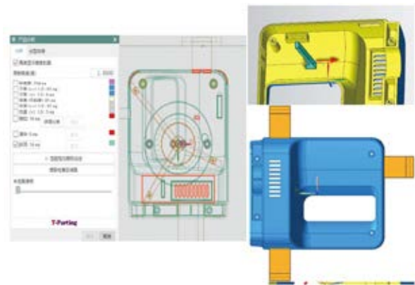
圖 6：倒扣滑塊位置分析與參考體建立
