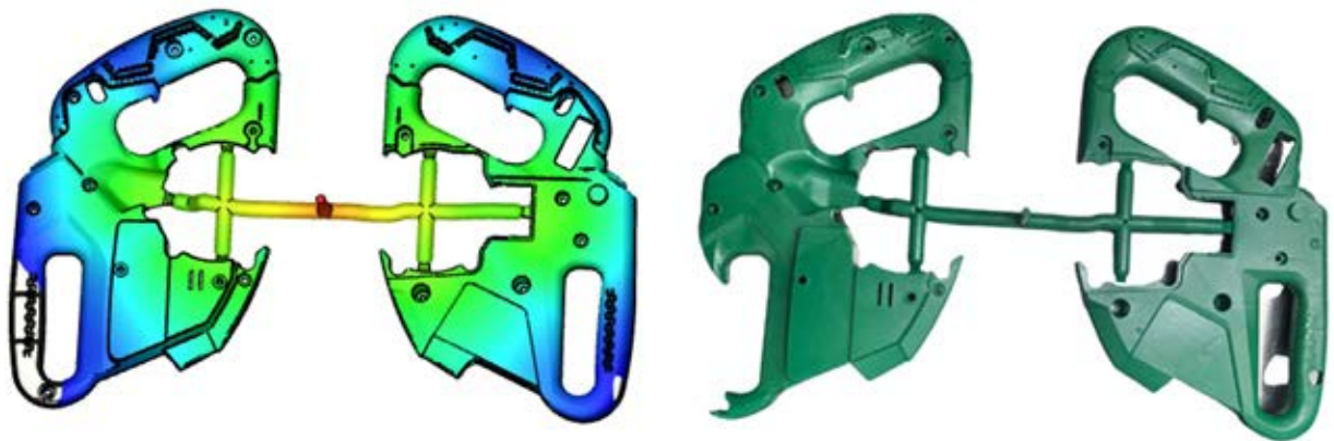
圖 8：該產品通過 Moldex3D 優化其流道設計與成型條件，並透過模流分析驗證其可行性
