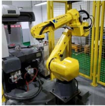
圖 1：電極加工自動化單元（包含電火花機、六軸機器人等）
