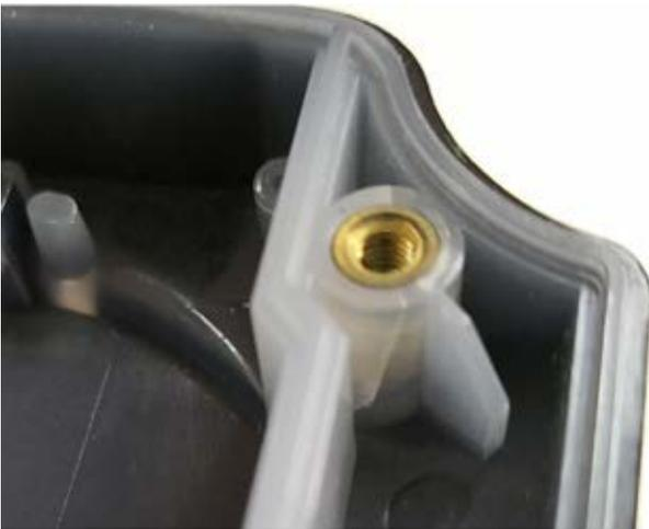
圖 14：輪穀產生的結合線二次加工埋入銅件之後造成破裂
