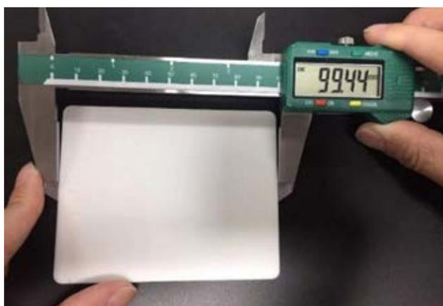
圖 5：ABS 材料射出樣板
