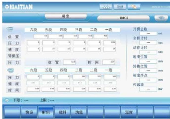
圖 12：模流分析成型工藝設定採用真實機臺操作界面
