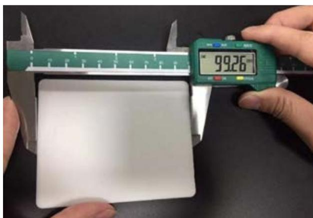
圖 6：低收縮改性 PP 材料射出樣板
