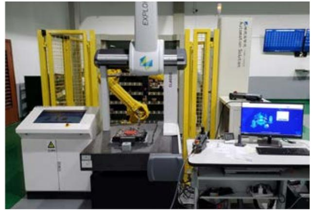
圖 3：電極自動化檢測單元
