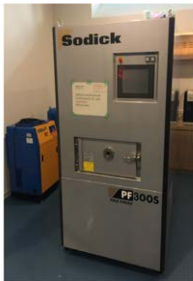
圖 1：左為 EBM 電子束照射加工裝置的構造；中間為 Sodick EBM 電子束照射加工設備 (PF-300S)；右為 EBM 電子束加工設備的加工室與加工工作臺
