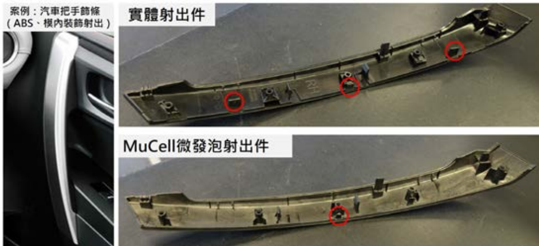
圖 7：本文案例「汽車把手飾條」的實體射出件與 MuCell 微發泡射出件之對照圖
