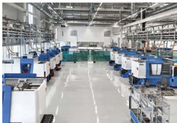
圖 5：Ypsomed 正在擴大生產，最近更在 Schwerin 新建了一家生產廠，配備了全電動 ENGEL e-motion 射出機（圖片來源：Ypsomed）
