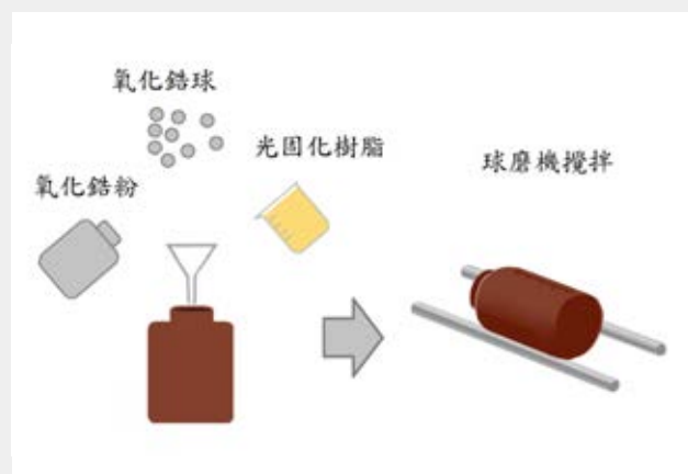
圖 3：氧化鋯漿料製備方法示意圖
