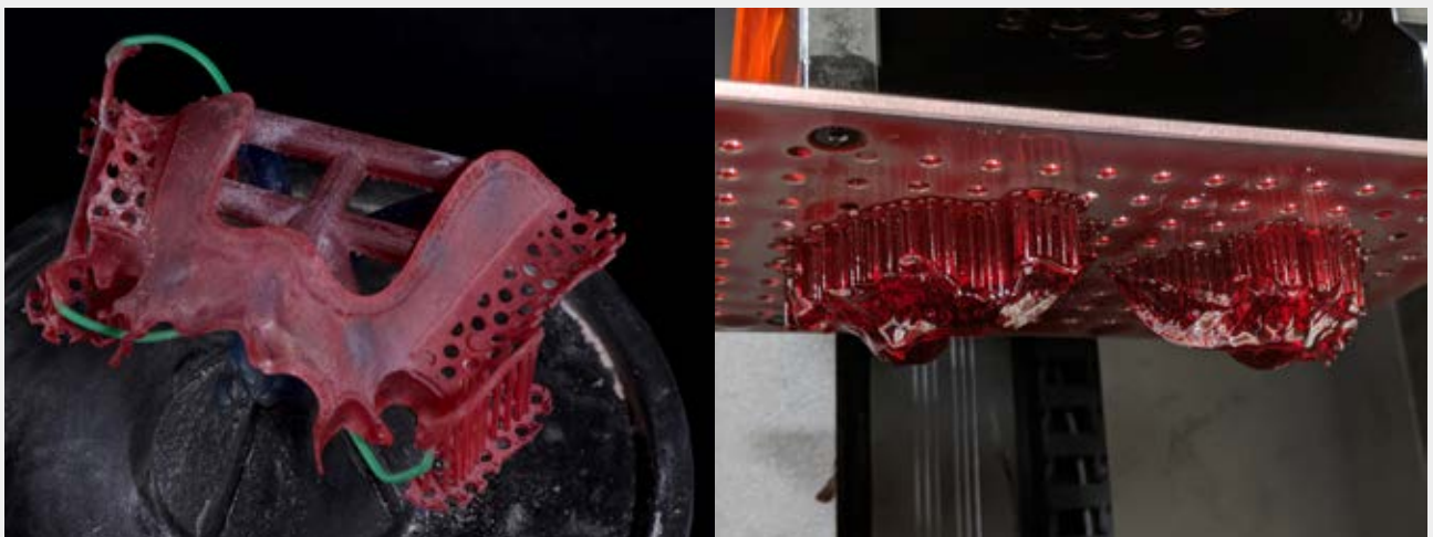
圖 4：列印光固化漿料蠟再鑄造鈷鉻金屬
