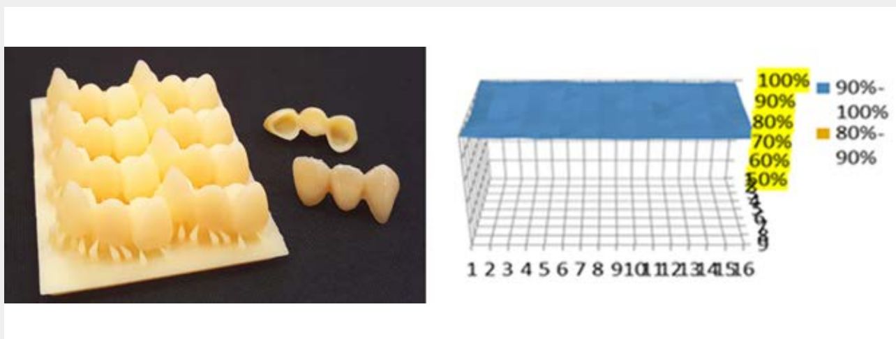
圖 5：完美的能量均勻度能創造成功的滿盤列印
