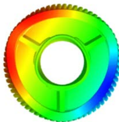
圖 14：斜齒輪的變形結果
