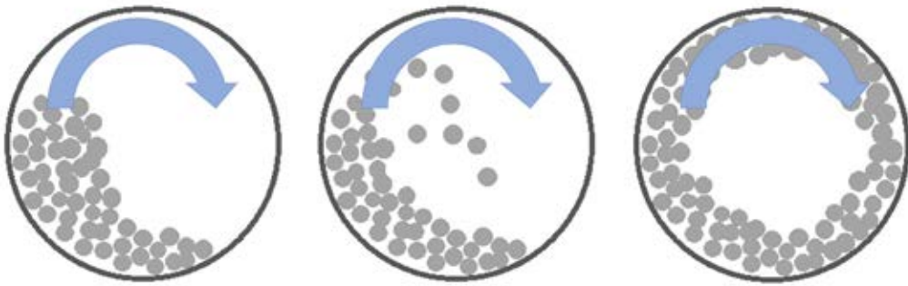
圖 4：氧化鋯球在球磨罐內的三種運動狀態示意圖
