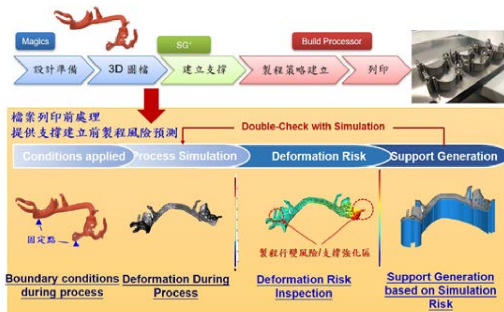
圖 4：數位牙材金屬積層製造生產流程
