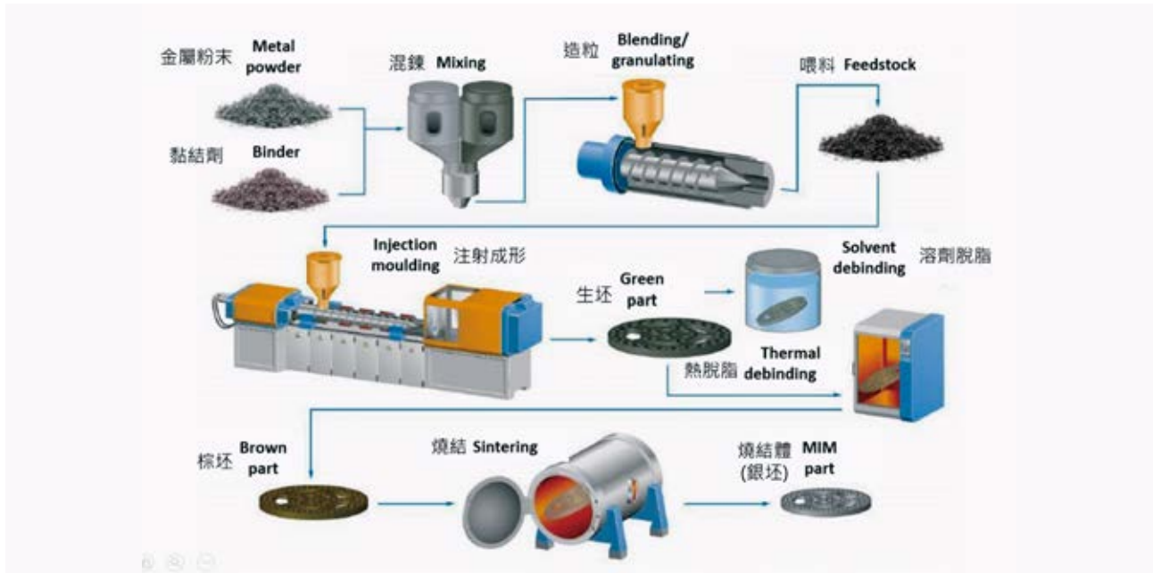
圖 2：金屬粉末注射成型的流程圖，這是溶劑脫脂與熱脫脂的蠟基喂料系統
