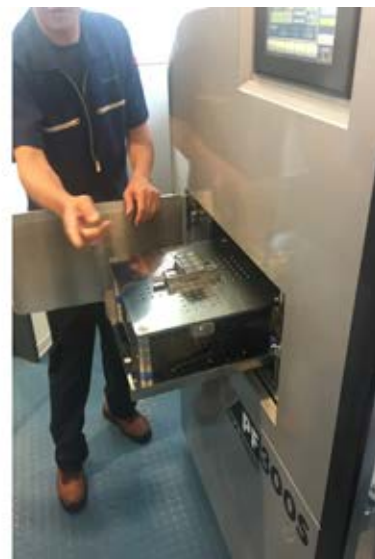
圖 1：左為 EBM 電子束照射加工裝置的構造；中間為 Sodick EBM 電子束照射加工設備 (PF-300S)；右為 EBM 電子束加工設備的加工室與加工工作臺
