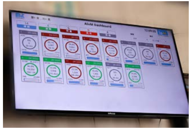
圖 2：廠內安裝的射出設備稼働率可視化系統
