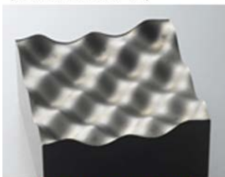
圖 9：STAVAX 金屬鋼材工件經過 EB 電子束照射加工的前後比對
