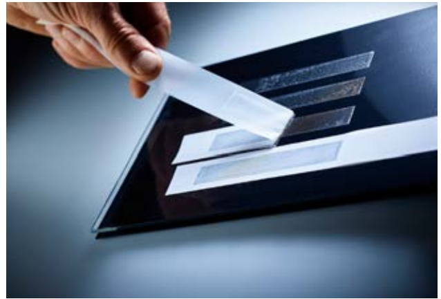
圖 2：膠黏劑測試條與 ABS 底板的附著力極佳，並已通過薄膜下拉快速測試予以證明
