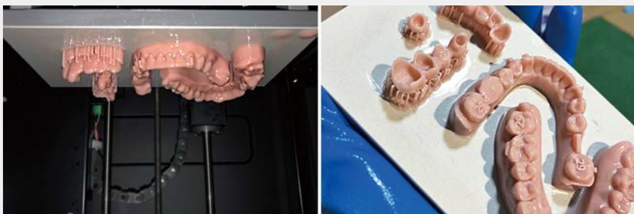
圖 2：牙模及假牙 3D 樣品，可供外型確認 / 模型演示，增加與病患治療期間的溝通、減少醫療糾紛，並同步供真空成型來製作成品
