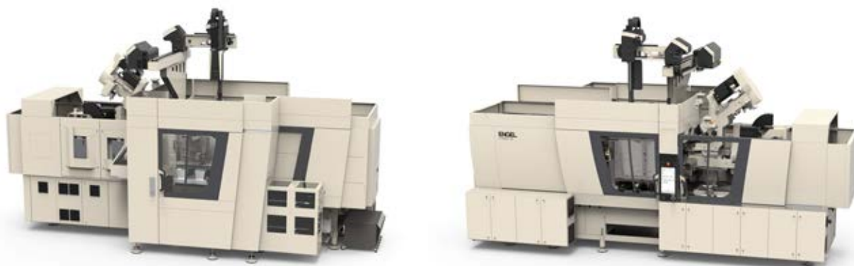
圖 1：“ENGEL compact cell” 在 K 2019 塑料與橡膠工業展上首次亮相，它包含所有自動化組件，比標準防護架窄得多（圖片來源：ENGEL）
