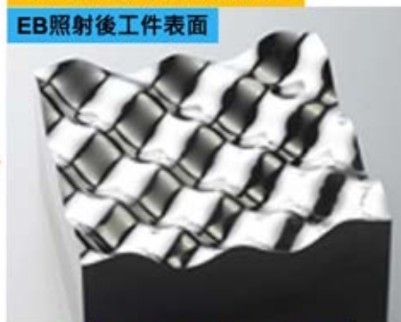
圖 9：STAVAX 金屬鋼材工件經過 EB 電子束照射加工的前後比對
