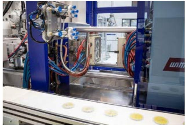
圖 2：SmartPower 120/350 LSR 的注射成型過程。兩腔模具打開，嵌入印刷電路板
