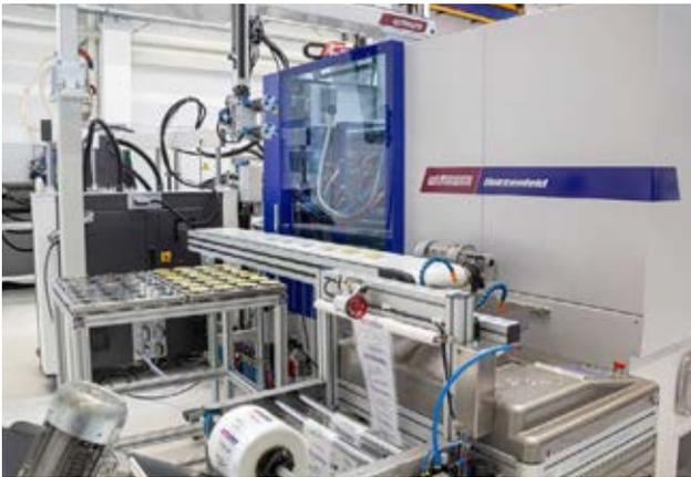
圖 3：SmartPower 120/350 LSR 的注射成型過程。將部件放到輸送帶上並送入包裝工作站
