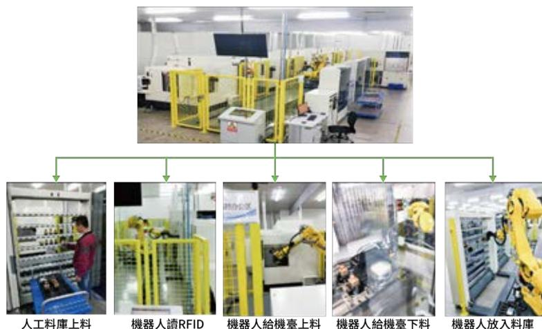
圖 3：CNC 全自動電極加工線
