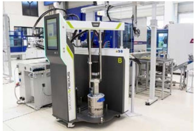
圖 4：SmartPower 120/350 LSR 注射成型機配備 Servomix X200 計量單元
