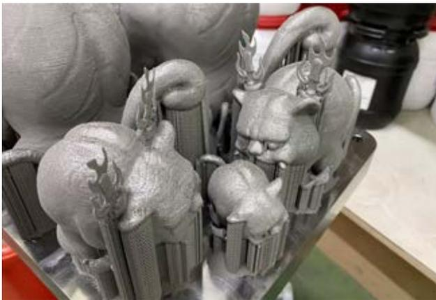
圖 3：以金屬 3D 列印機搭配鈦合金材料，製作金屬製模型
