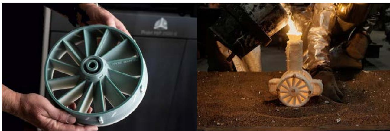
圖 5：從列印成型到脫蠟鑄造
