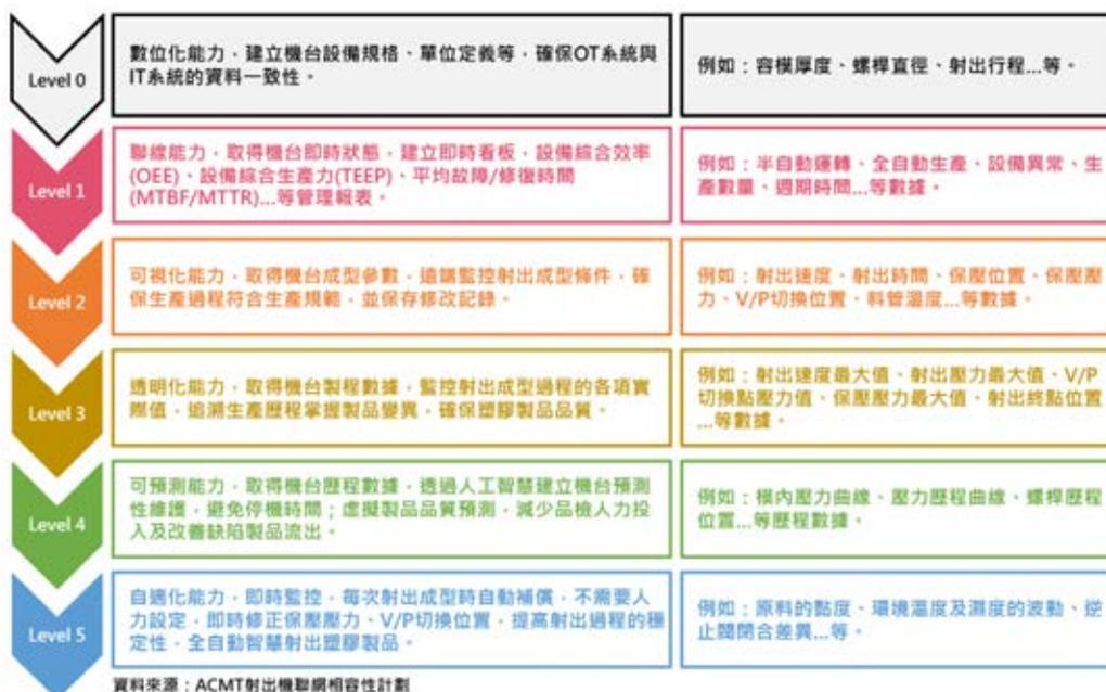
圖 4：ACMT 射出機聯網相容性計劃 1+5 階智慧製造應用
