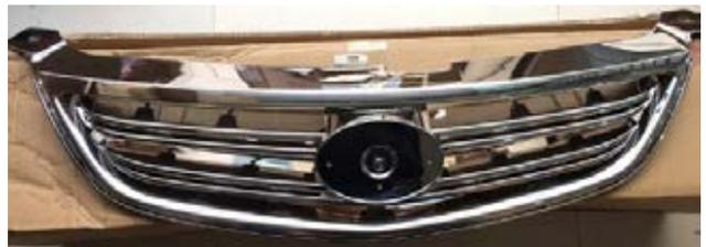
圖 4：金暘電鍍 PC/ABS 合金材料應用於某品牌汽車格柵
