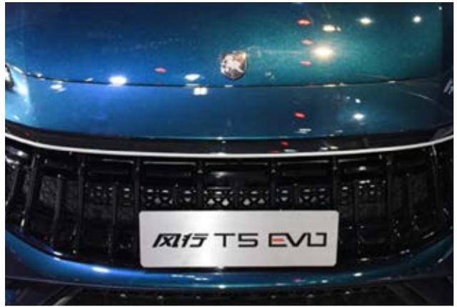
圖 2：金暘高光免噴塗 PMMA/ASA 合金材料應用於風行 T5 EVO 進氣格柵
