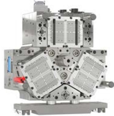
圖 4：憑藉一副 32 腔的模具以及 6 ~ 8s 的循環時間，加工商們利用一個單獨的生產單元，每分鐘能生產出 320 個檢測拭子，一天則能生產出 460,000 個檢測拭子（圖片來源：ENGEL）
