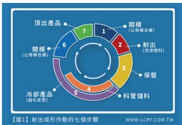
圖 1：射出成型作動的七個步驟
