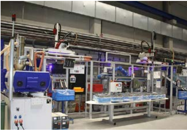
圖 1：通過帶緩衝能力的輸送系統連接在一起的威猛巴頓菲爾 EcoPower 110/350 射出機全視圖（圖片來自威猛巴頓菲爾）
