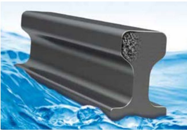
圖 1：由 PA+PP 材料共混得到密度小於 1g/cm 3 、比水更輕的共混物
