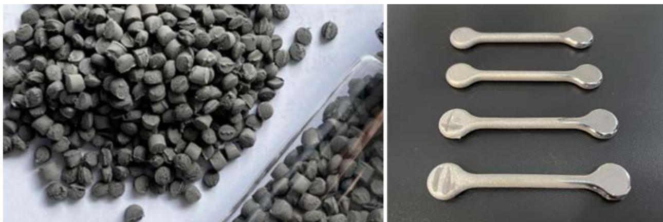
圖 4：考慮鈦與鈦合金的操作安全，MIM Extra<sup>®</sup> POM 基喂料產品是業界可以如方便面打開即用的安全喂料。（左）MIM Extra<sup>®</sup> TC4 POM 基喂料；（右）經過注射成型並脫脂燒結後，在右端拋光的狗骨頭拉伸試棒
