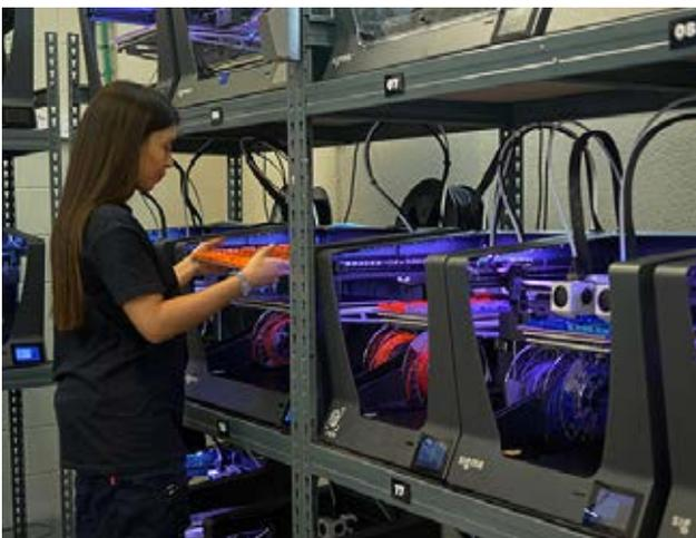
圖 7：BCN3D Sigma D25 3D 列印機，能同時 3D 列印兩個完全相同或左右對稱的物體
