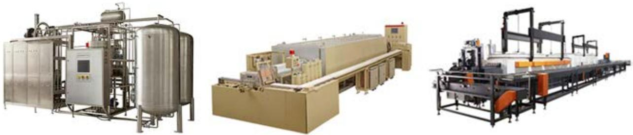
圖 2：(左) 溶劑脫脂爐含有回收桶；(中) 推杆式氣氛保護連續燒結爐；(右) 步進梁 (Walking beam) 式氣氛保護連續燒結爐
