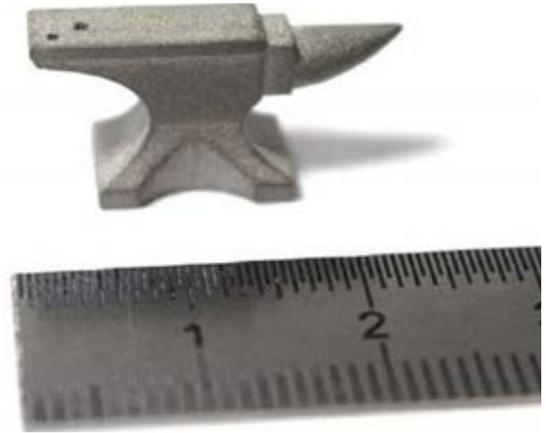
圖 7：左是由鈦喂料絲列印製成的演示零件（德國德索斯頓弗法 IFAM）；右則是由鈦光固化列印製成的演示零件（由奧地利 Incus GmbH 製造，在德國元素 22 GmbH 上燒結）
