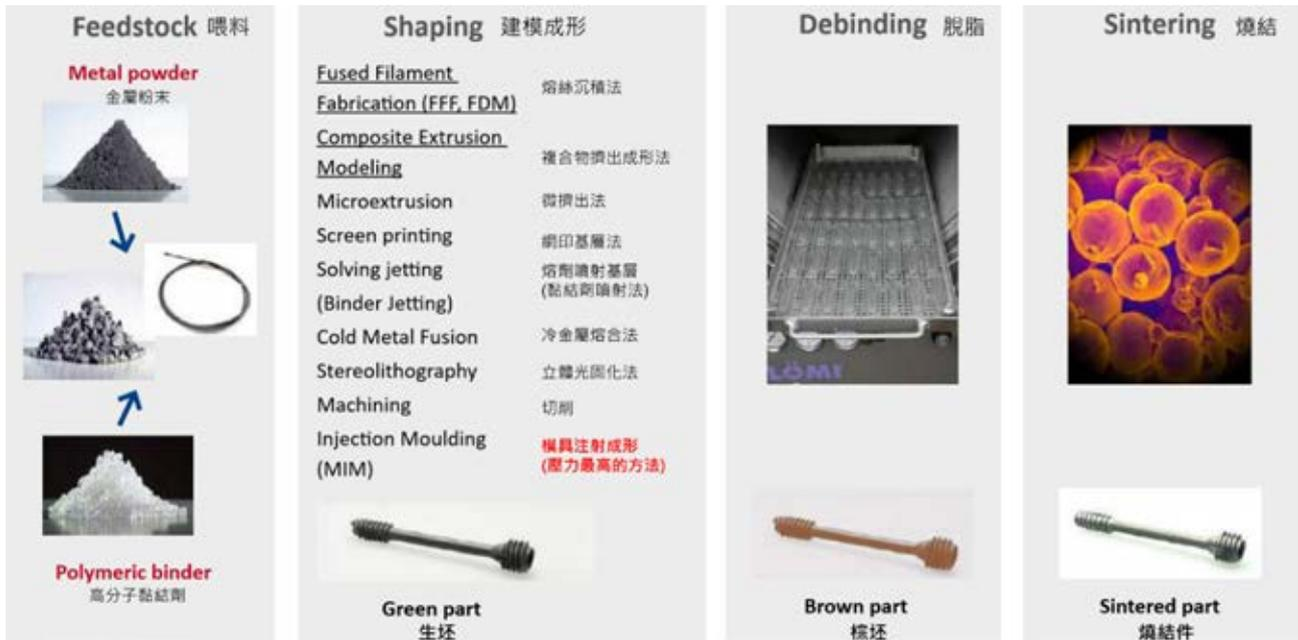
圖 5：以 MIM 喂料加工方案——AM 的建模成型方法變得非常靈活
