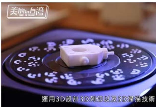
圖 2：GiT 港擎科技產品設計經理，使用 3D 掃描器及 360 度自動旋轉盤，建立一個零件電子檔平均只要 5 分鐘
