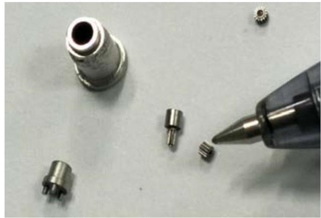
圖 6：(左) 由 FFF 用 Ti-6Al-4V 粉末所列印的演示齒輪組合（德國埃默里奧利奧化學有限公司開發的黏合劑系統，在元素 22 公司內進行脫脂和燒結）；(右) 使用傳統粉末注射成形齒輪的限制在於零件尺寸過小時，模具對於螺紋與協齒輪無法製做，只能製作正齒輪（右圖由 Dr. Q 拍攝）
