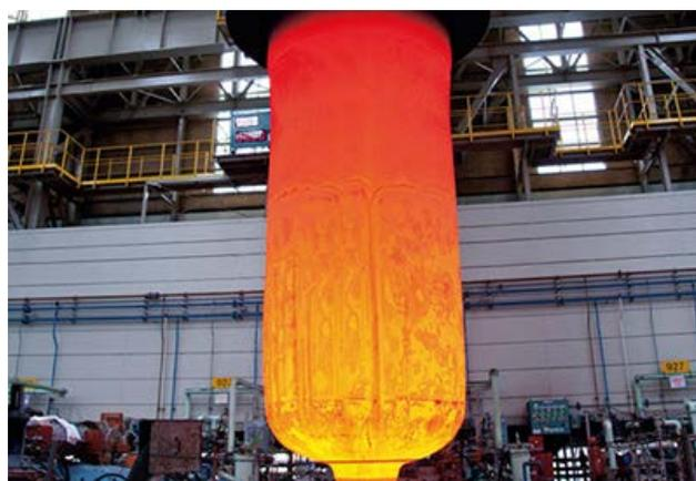
圖 2：原料端——海綿鈦的製造
