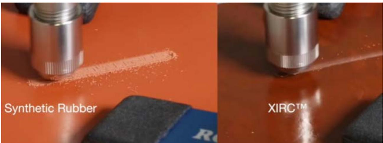
圖 6：與合成橡膠（左）抗磨損試驗
