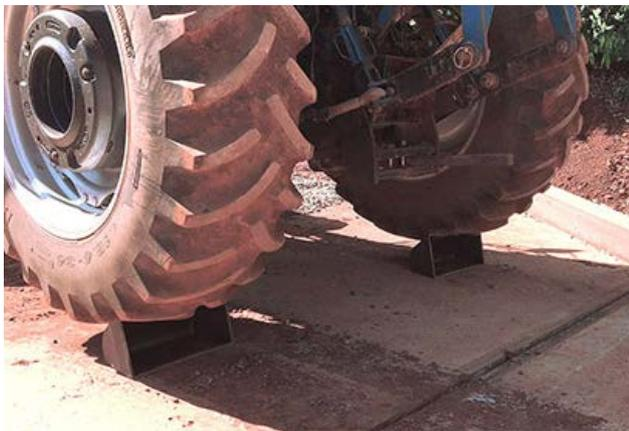
圖 3：以 AKROLOY® PARA ICF 40 製成的塑料鏟斗成功通過 6.5 噸重的拖拉機碾壓測試，承受淨重高達 3.5 噸
