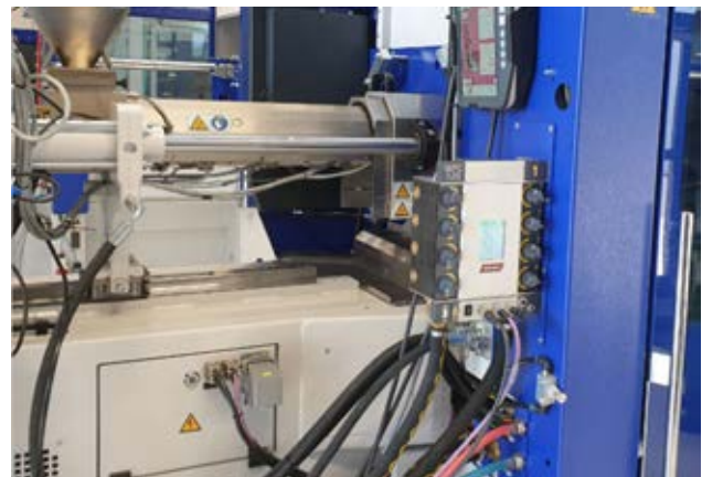
圖 3：WFC 120 的安裝位置緊鄰威猛巴頓菲爾射出機上的模具
