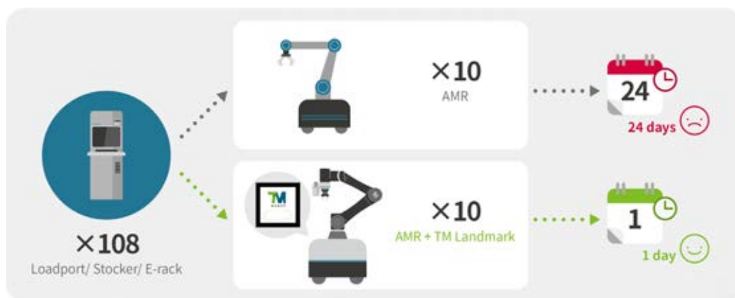
圖 1：透過 TM 獨家專利 TM Landmark ——跨手臂點位共用套件，快速複製點位，只需要 1 個工作天即可快速完成 108 個 loadport 的設定，效率提升數十倍
