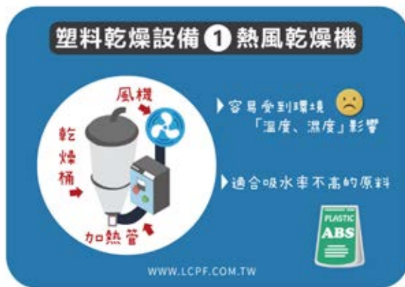
圖 4：熱風乾燥機的簡易說明
