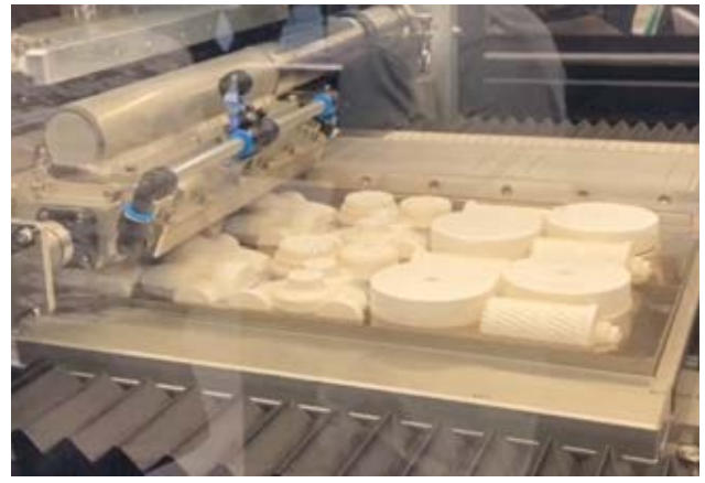
圖 4：噴射陶瓷 3D 印表機列印倉
