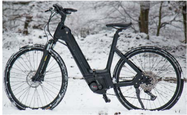
圖 2：為使自行車更加輕巧靈活，V-Frame 的全塑膠骨架方案取消了頂杆設計
