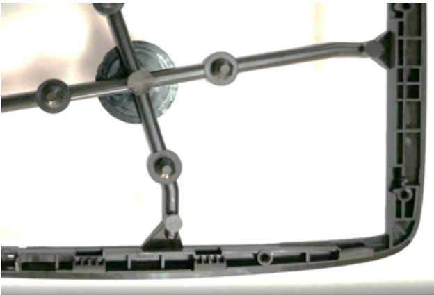
圖 1：塑膠射出成型部件
