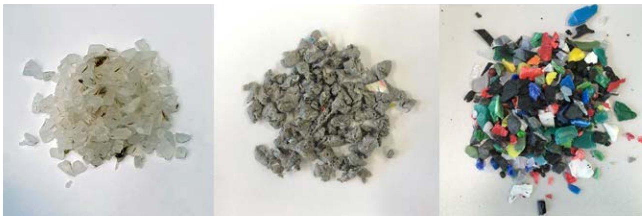
圖 1：使用三種不同材料進行試驗，分別為 PP 新材料顆粒（左）、來自消費後薄膜的 PP 附聚物（中）和來自 HDPE 飲料封蓋的磨料（右）
