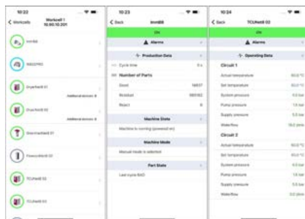
圖 2：QuickLook 4.0 屏幕視圖，從左到右為生產單元中的設備、射出機的生產數據、模溫機的運行數據
