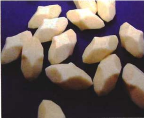
圖 4：（左）以電腦數值分析模擬出最佳堆積密度的粉體形狀，非常適合用來金屬粉末注射成形；（右）市面上販賣的硬殼糖漿的巧克力糖的形狀，如果 MIM 的粉末可以作成這樣的外型是最好的
