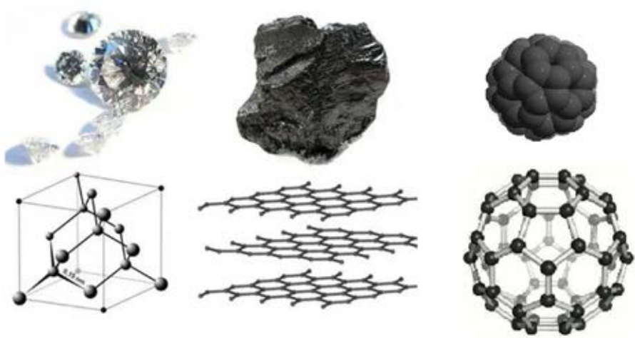
圖 2：碳元素的多固相——左起鑽石 / 石墨 / 富勒烯
