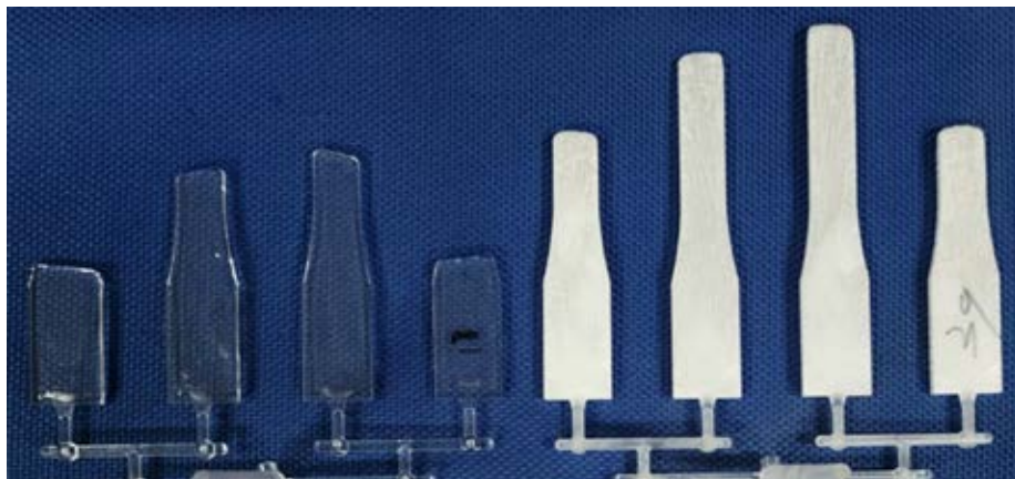
圖 3：聚碳酸酯未發泡和發泡的流動長度
