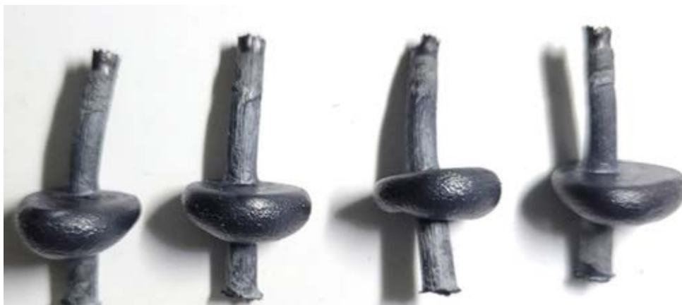
圖 4：堵住射嘴的冷料頭
