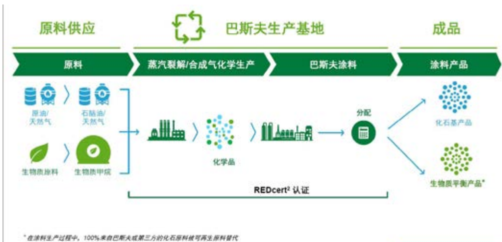
圖 3：巴斯夫使用可再生原料替代了生物質平衡產品所需數量的化石資源來製造汽車塗料
