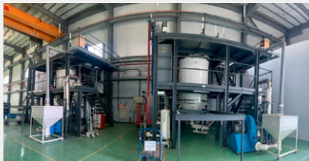
圖 2：真空金屬粉末氣體霧化設備
