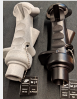
圖 6 : 左為處理前零件，右為處理後零件 [7]
