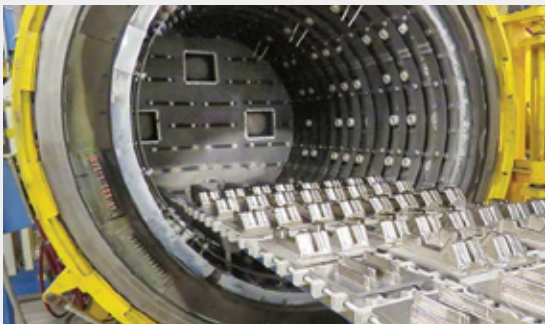
圖 13：將零件置於真空爐中熱處理 [11]
