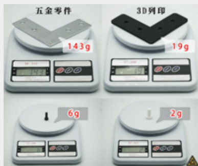
圖 1：透過 3D 列印內部零件達到輕量化
