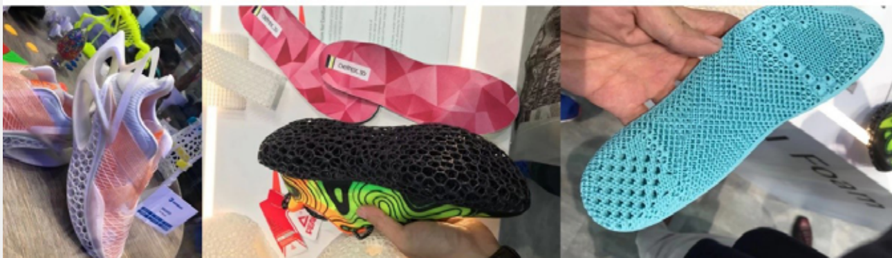
圖 5：晶格結構設計 3D 列印於運動鞋之應用（圖片來源：臺科大高速 3D 列印研究中心）
