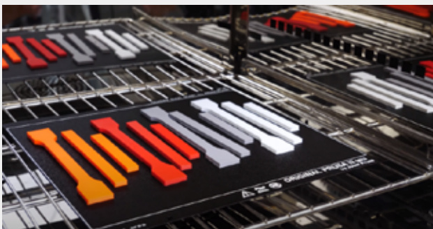
圖 11：將零件置於烘箱中熱處理 [10]
