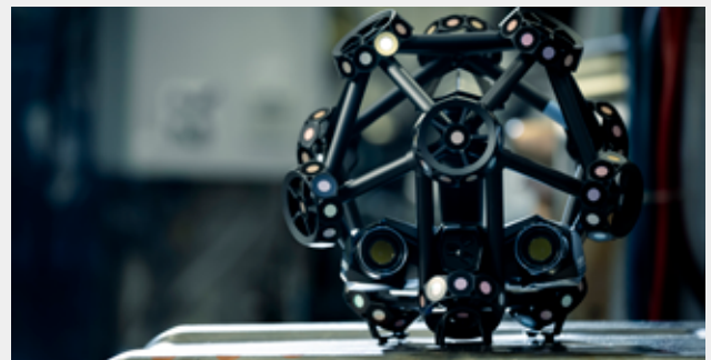
圖 2：新款 MetraSCAN Black 系列具 15 條藍光雷射十字 線、精度高達 0.025mm
