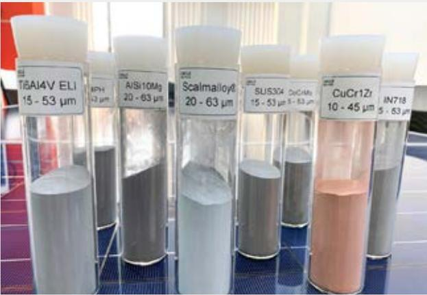
圖 1：除航太鋁合金 Scalmalloy® 外，金屬 3D 列印還可列印銅合金、不鏽鋼、鈦合金、超鎳合金等材質
