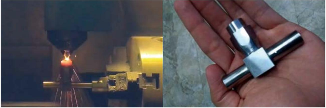
圖 2：左為 LENS 系統搭配四軸加工機，右為加工成品 [3]
