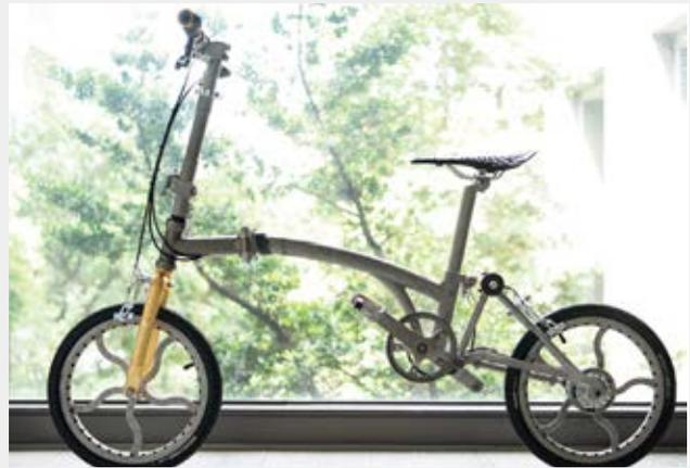
圖 2：折疊自行車結合鈦合金、鋁合金、銅合金，從車架、前叉、傳動、腳踏與輪框皆為金屬 3D 列印
