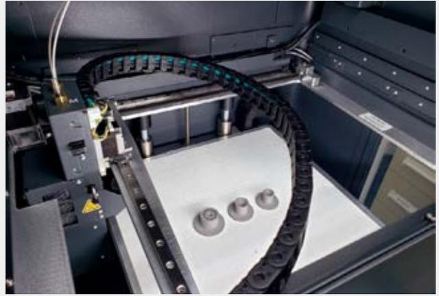
圖 2：Shukla Medical 以 17-4 PH 不銹鋼列印零件原型
