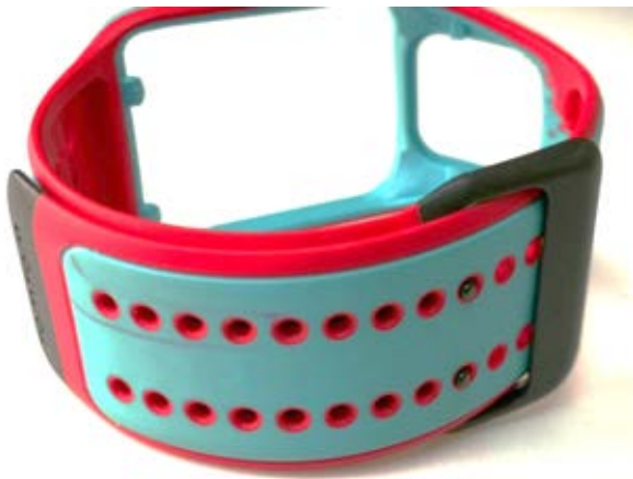
圖 8：二射高溫造成一射再融表面出現痕跡
