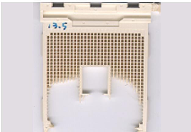
圖 3：模具產品試模短射圖
