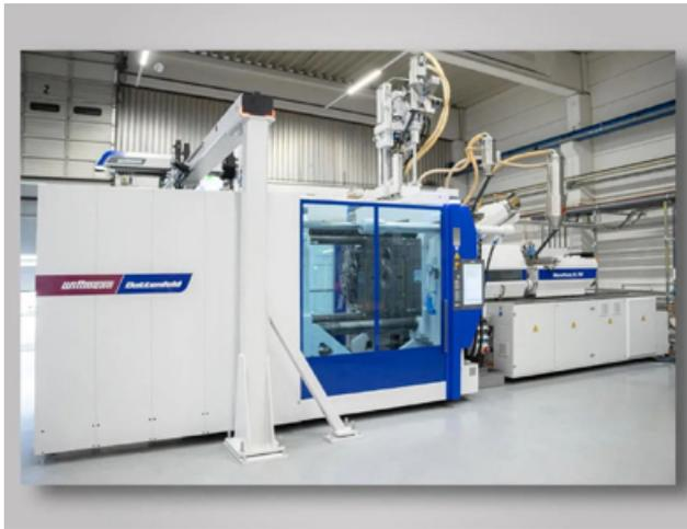
圖 2：MacroPowerXL700/3400H/350S/210V Combimould 多組分射出機
