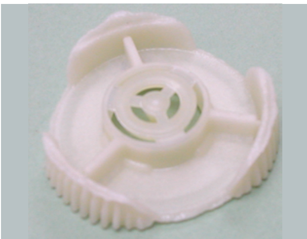
圖 10：斜齒輪射出短射圖
