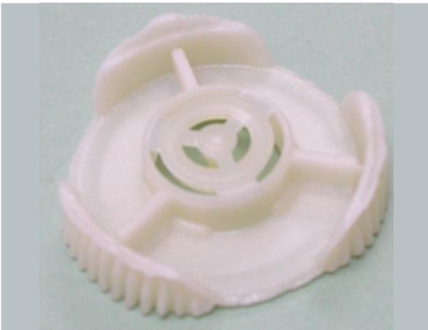
圖 10：斜齒輪射出短射圖
