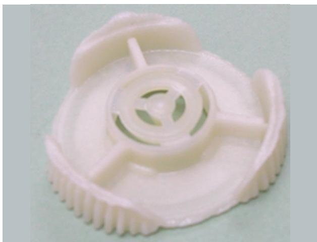
圖 10：斜齒輪射出短射圖
