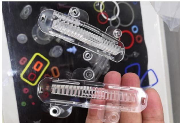
圖 2：LSR 材質的車燈控制光電控制器配件
