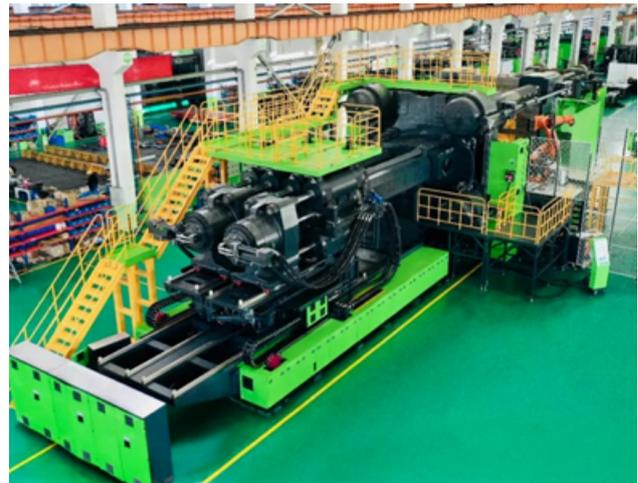
圖 4：伊之密 8500T 超大型高精度射出成型機
