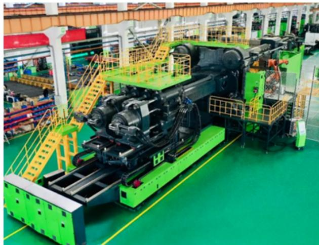
圖 4：伊之密 8500T 超大型高精度射出成型機
