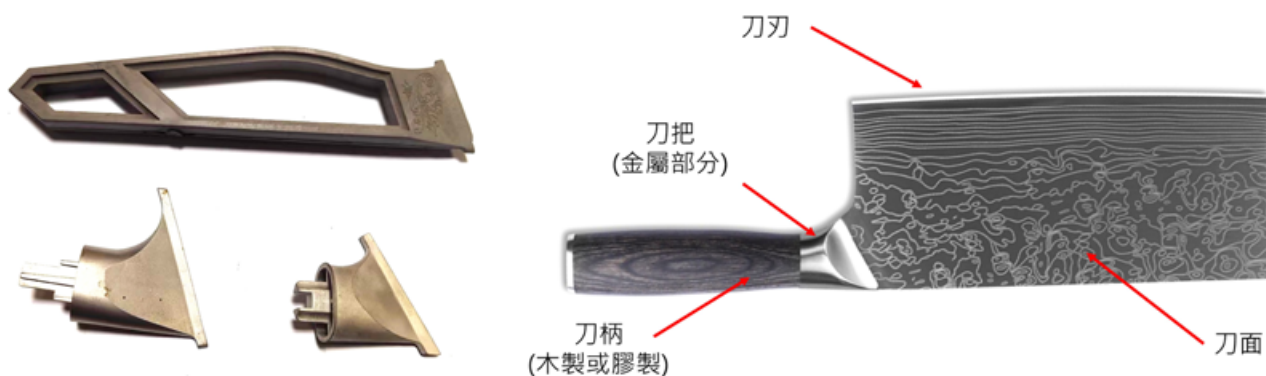
圖 2：(左)MIM 注射出的菜刀刀把，上面是 420 整個刀把生坯；下面二個是刀把頭部，這些用 MIM 注射的零件，右前端會和刀片焊接在一起、左後端則與木材刀柄結合，成為一把完整的菜刀（圖片由廣東潮藝金屬實業有限公司提供）；(右)完整的一把菜刀
