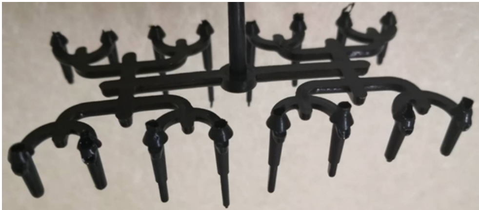
圖 3：一模 16 穴完全對稱的設計。在射出時，次流道出現長短腳的情況
