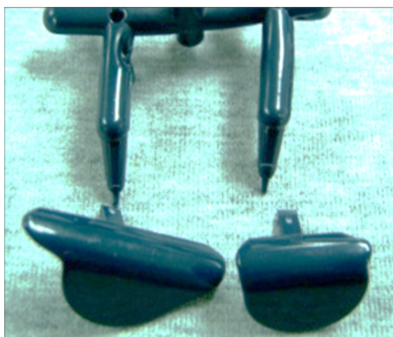
圖 11：因流道長短腳造成充填體積不同的實際短射產品圖
