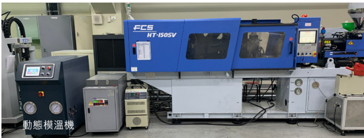
圖 8：動態模溫設備與模具整合上機測試
