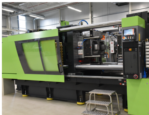
圖 2：ENGEL e-motion 550——全電動射出機，鎖模力為 5,500 kN，最大托盤間距為 1,480 x 1,480mm。該機器可容納總重量達 7.3 噸的模具
