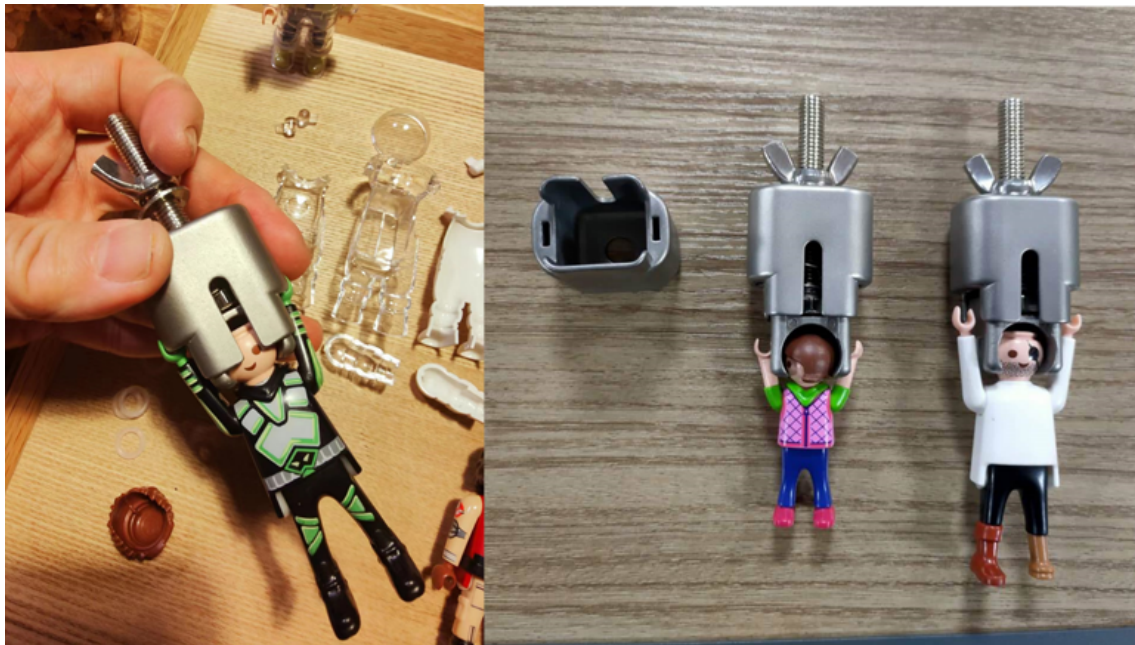
圖 2：Dr. Q 利用 MIM 工藝自己設計的玩偶拔頭器
