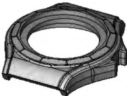
圖 1：結合 CAD 技術系統所設計出的手錶殼體塑件模型
