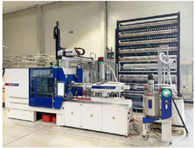
圖 2：配有威猛自動化系統的 SmartPower 240/1330 射出機（圖片來自 Schauenburg）
