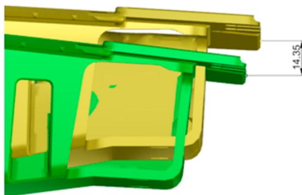
圖 4：原始 CAD 模型與模擬之翹曲模型疊圖比較
