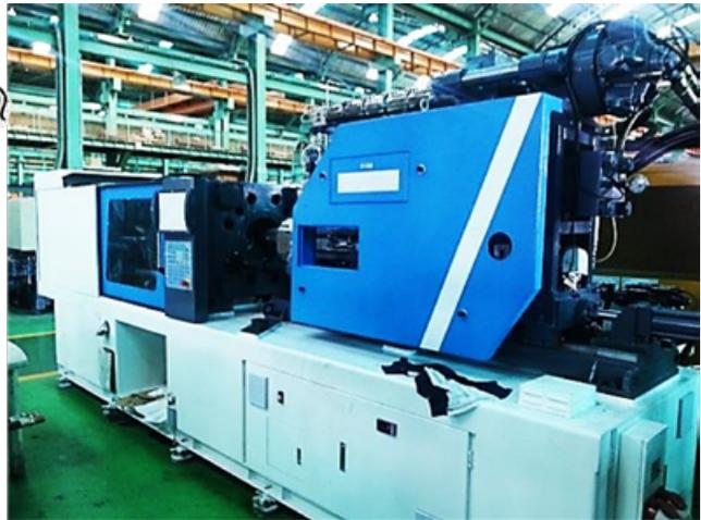
圖 3：三段式射出單元——新型長纖維射出成型機
