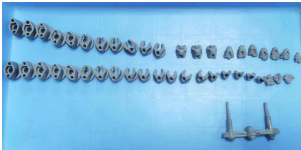
圖 3：MIM 射出成型過程的短射觀察——必須根據截面積變化來進行
