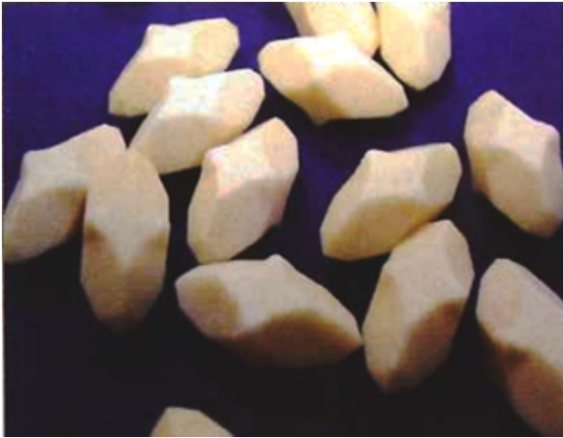
圖 3：電腦數值計算粉末成型用的粉末其最佳外型類似米粒
