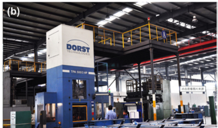
圖 3：(a) 極為複雜的粉末冶金壓製用模架，以提供更多的產品特徵（圖片來自華南理工大學專利說明書 CN1238139C）；(b) 寧波東木工廠內一部大型的粉末冶金壓機，地下高度和地面高度是一樣的，可以製作非常大的粉末冶金製品（圖片由寧波東睦提供）
