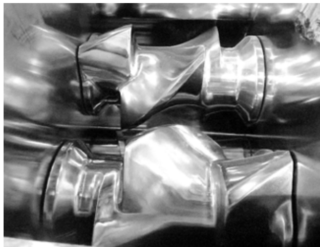
圖 4：昶豐最新一代的混料造粒一體的攪拌轉子比較。(左) 舊的二槳葉；(右) 新的四槳葉 (東莞昶豐提供)
