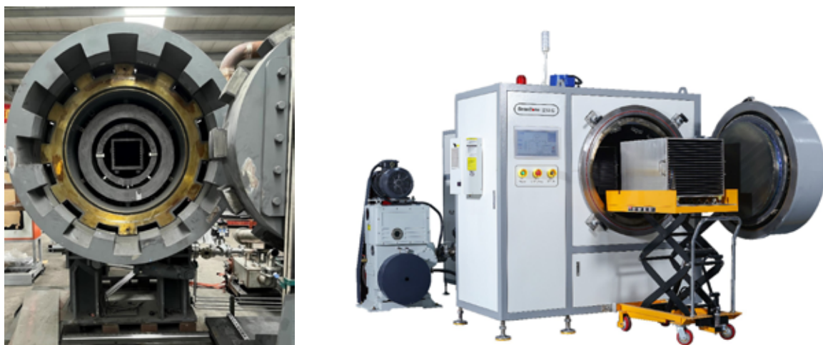
圖 5：（左）一個 20MPa 高壓燒結爐被用來作為 MIM 生產使用（廈門至隆提供的圖片）；（右）星特燦最新一代的脫脂與預燒結一體爐也被用來做為 MIM 製造的設備也在 2023 發表（深圳星特燦提供）
