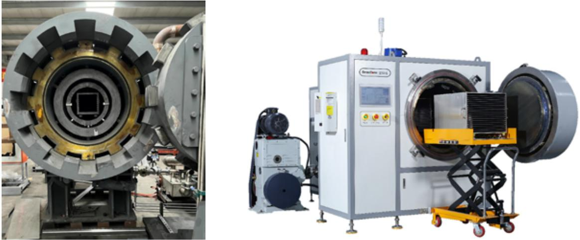
圖 5：（左）一個 20MPa 高壓燒結爐被用來作為 MIM 生產使用（廈門至隆提供的圖片）；（右）星特燦最新一代的脫脂與預燒結一體爐也被用來做為 MIM 製造的設備也在 2023 發表（深圳星特燦提供）
