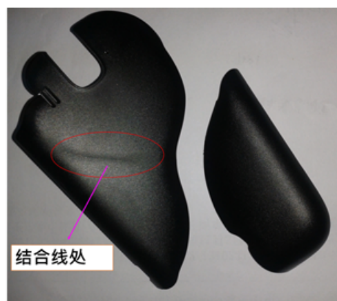
圖 2：由進澆數量引起縫合線的流動結果及實際樣品圖
