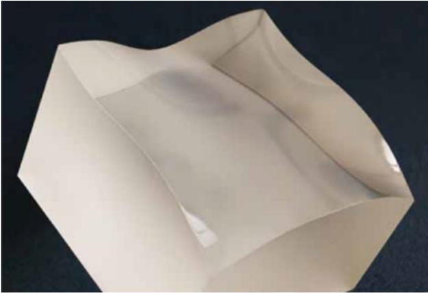
**圖 1：此玻璃工件的自由曲面是使用 Röders 5 軸高速加工機 RXP501DS 搭配鑽石工具進行拋光（照片提供：Shape Fab）**
