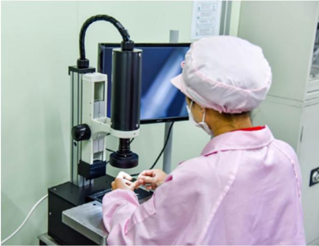
圖 1：投放式顯微鏡
