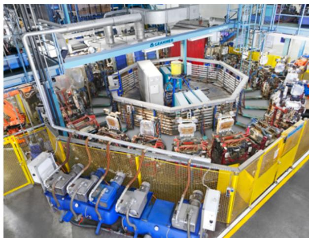
圖 2：Grammer 公司使用擁有 24 個工位的轉檯系統生產帶有標誌性稜紋靠背的座椅
