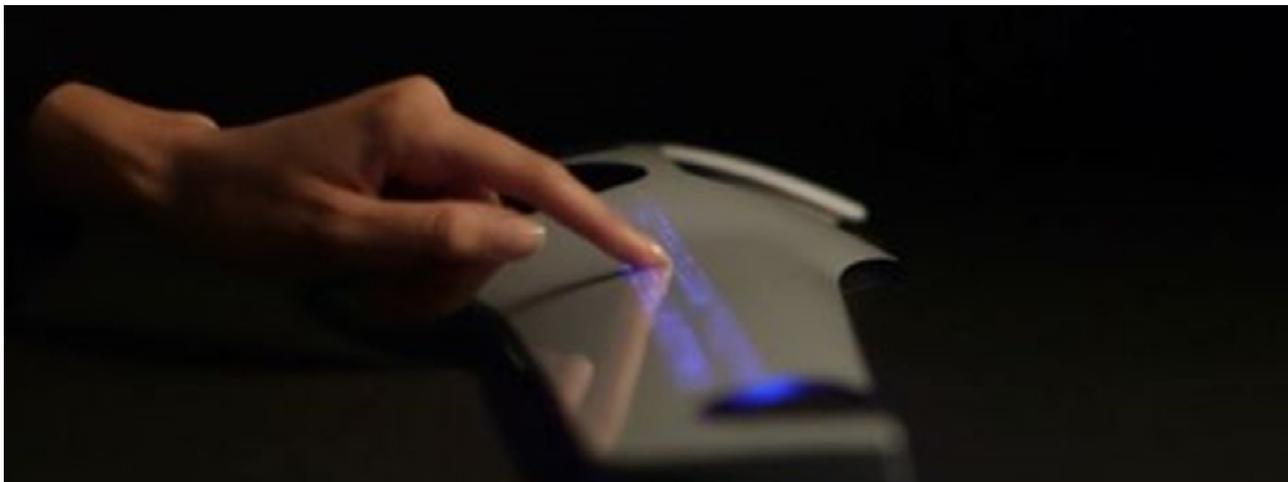
圖 3：使用 PMD 生產的表面可以配備集成電容式傳感器
