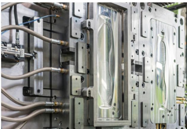
圖 3：展示 IMD PUR 工藝的注塑模腔（圖片來源：Kurz 官方網站）
