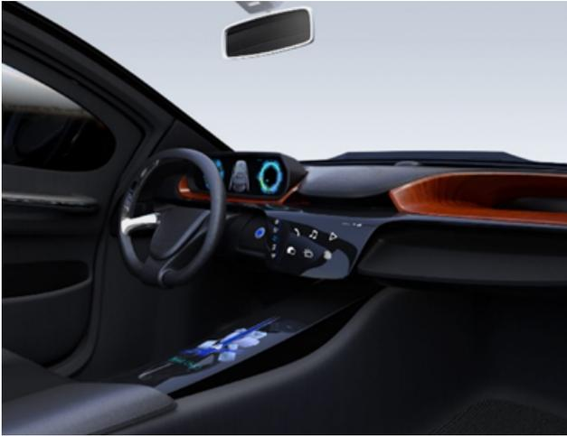
圖 2：IME 智能表面可以替代機械按鈕實現極簡外觀或面板
