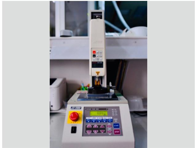
圖 4：自動拉壓力測試台
