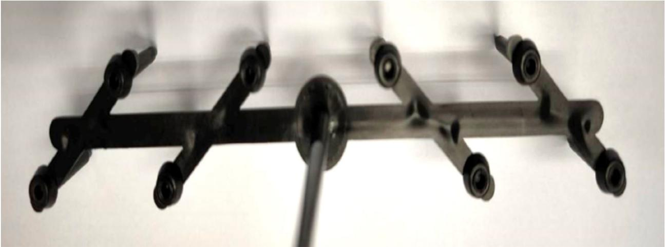
圖 1：一模 8 穴流道設計 (非平衡設計)
