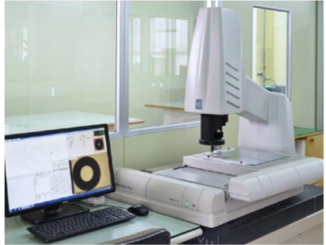
圖 2：Micro-Vu 非接觸式投影量測系統
