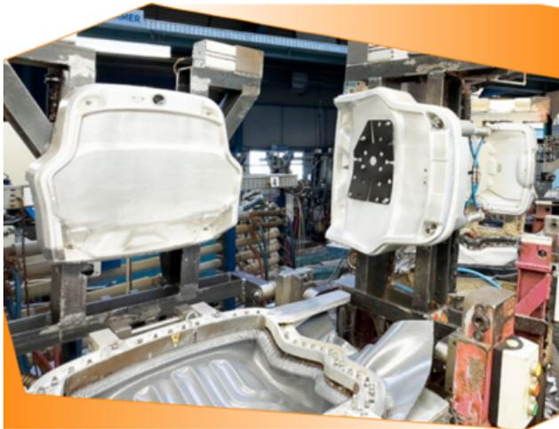
圖 3：每個模具都有兩個不同幾何形狀的蓋子（蓋體），因此也可以用硬泡生產支撐件
