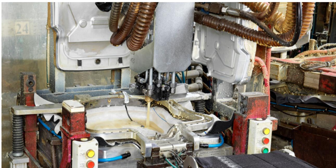
圖 5：在澆注過程中，混合頭決定泡沫的均勻性從而決定了座椅的質量
