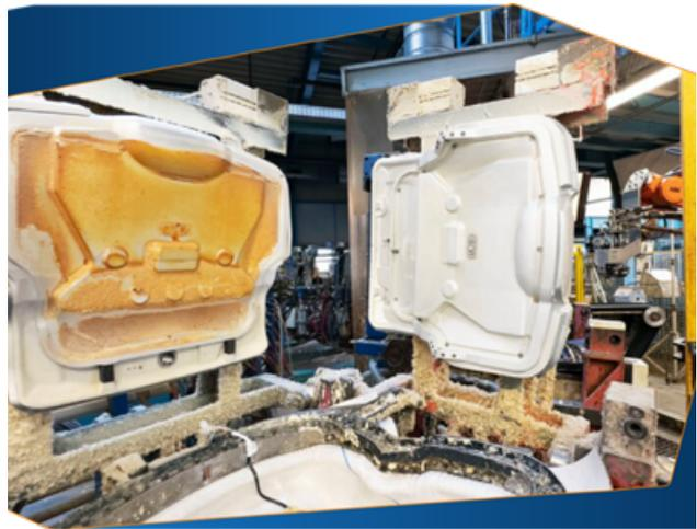
圖 4：座椅加熱元件也可以集成到發泡系統中
