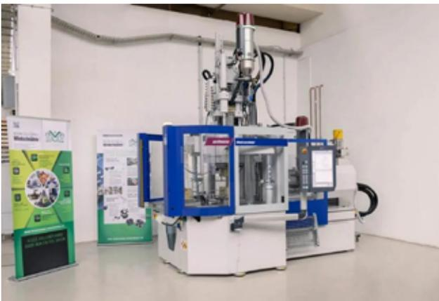
圖 3：VPower 120/130H/210V 雙組分射出機在客戶工廠
