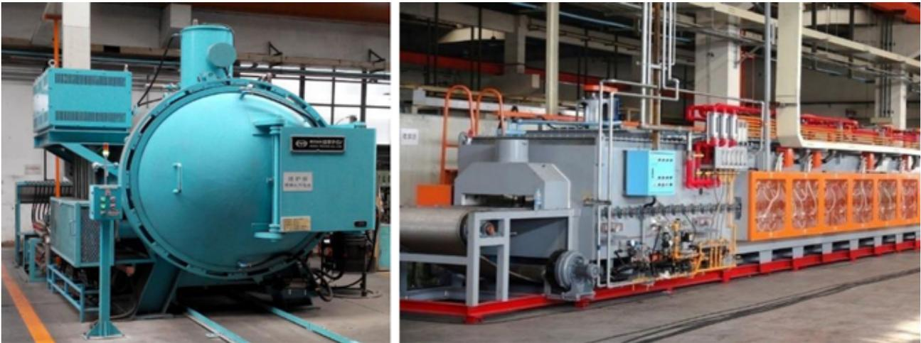
圖 3：(左) 批次式的真空熱處理爐是 MIM 零件最經常使用的爐型，可以自動執行完整個熱處理所需要的程序，不需要再更換設備；(右) 連續式的熱處理針對大批量產品適用。(本圖係由台灣的鑫光金屬工業股份有限公司與大陸的鑫光熱處理有限公司聯合提供)
