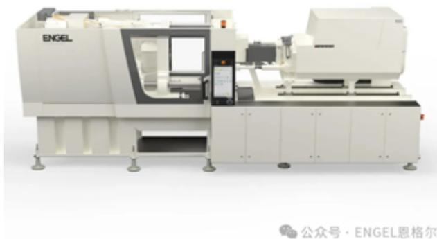
圖 5：在展臺上，一台 ENGEL e-mac 100 使用中國模具製造商 Cartisan（漢匠）的八腔模具生產 PP 材質的特殊移液頭（圖片來自：ENGEL 微信公眾號）
