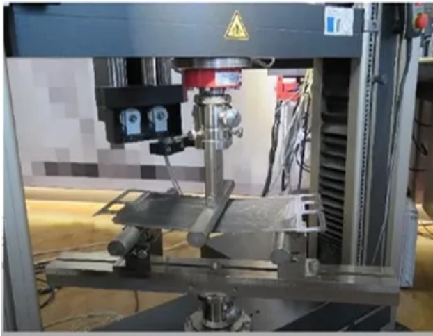
圖 5：雙極板彎曲測試
