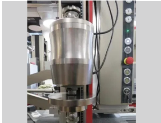
圖 6：密封圈氣密性測試
