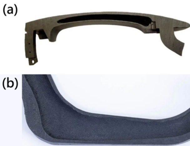
圖 4：圖 (a) 為門把手內部的 Airmould 氣流通道；圖 (b) 為油門踏板的 Airmould 氣流通道
