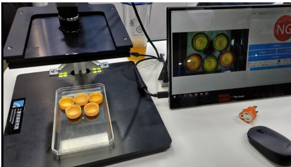
圖 1：導入 AOI 技術，經由色彩演算法及工件辨識，可直接在生產過程中即時監測，加速排除問題從而提高生產穩定性
