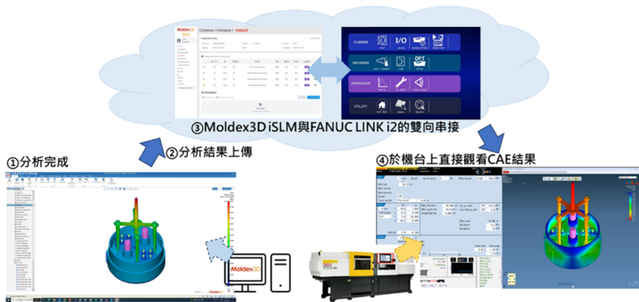
圖 1：Moldex3D 與 FANUC ROBOSHOT 射出機整合流程
