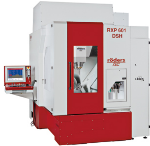
圖 6：Röders 高速五軸銑床 RXP 601 DSH，可以滿足客戶最嚴格的精度和高速切削性能要求，即使加工硬脆材料時也是如此
