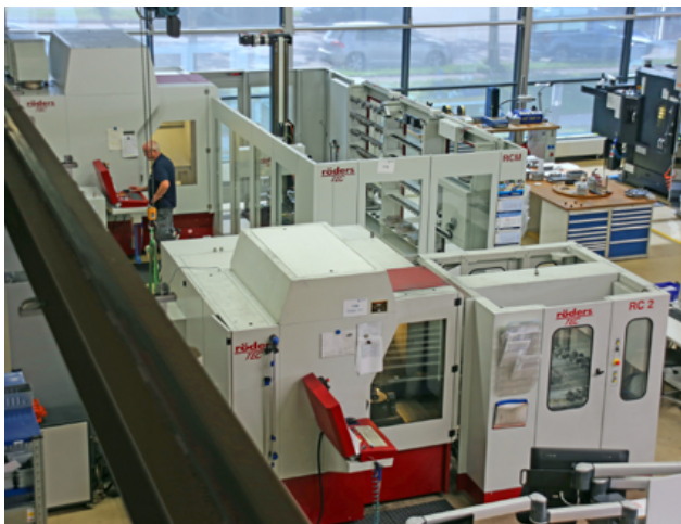
圖 3：兩台配置自動化的 Röders 設備。照片下方是一台 RXP 500 DS 配置 RC2，上方則是一台 RXP 601 DSH 配置具擴充性的 RCM，用於工件和工具加工（照片：Klaus Vollrath）
