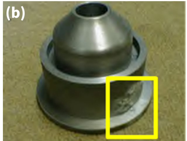
圖 3：(a) 金屬零件破損（黃框）；(b) 金屬零件冷噴修復（黃框）
