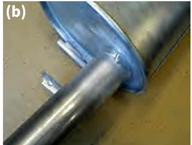
圖 2：(a) 汽車零件表面已腐蝕；(b) 汽車零件冷噴表面修復外加一層保護層
