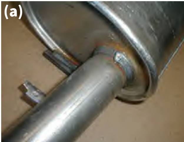
圖 2：(a) 汽車零件表面已腐蝕；(b) 汽車零件冷噴表面修復外加一層保護層
