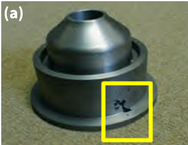
圖 3：(a) 金屬零件破損（黃框）；(b) 金屬零件冷噴修復（黃框）
