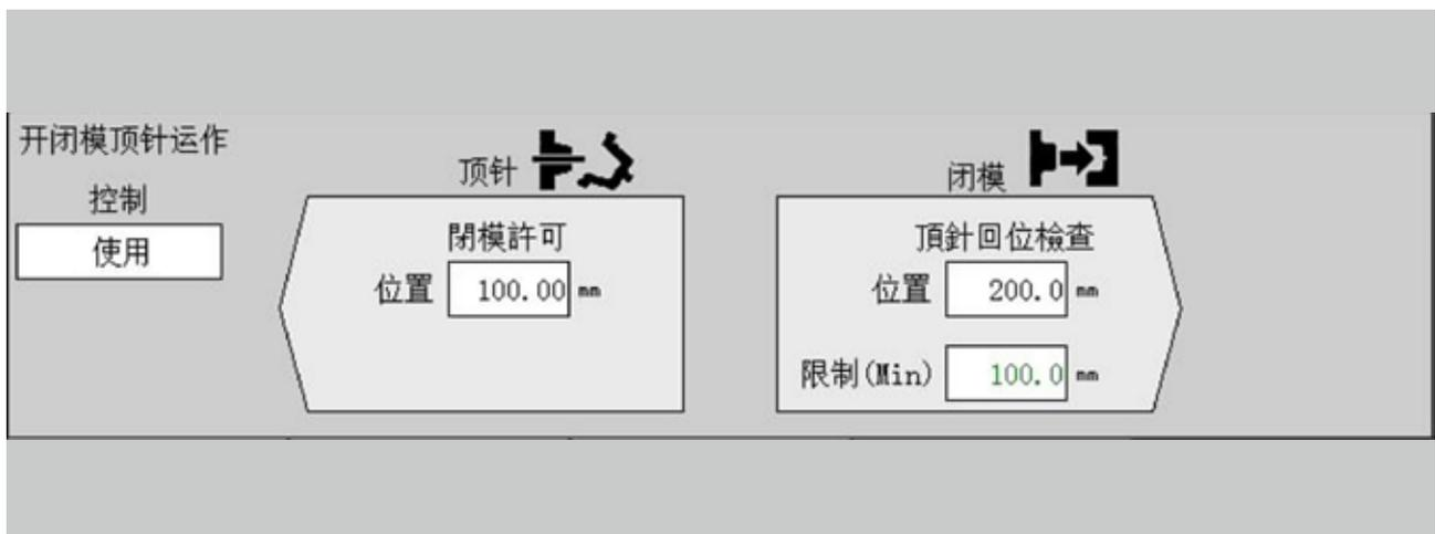
圖 10：使用圖中這個可選功能時，可在頂針回位時實現閉模動作
